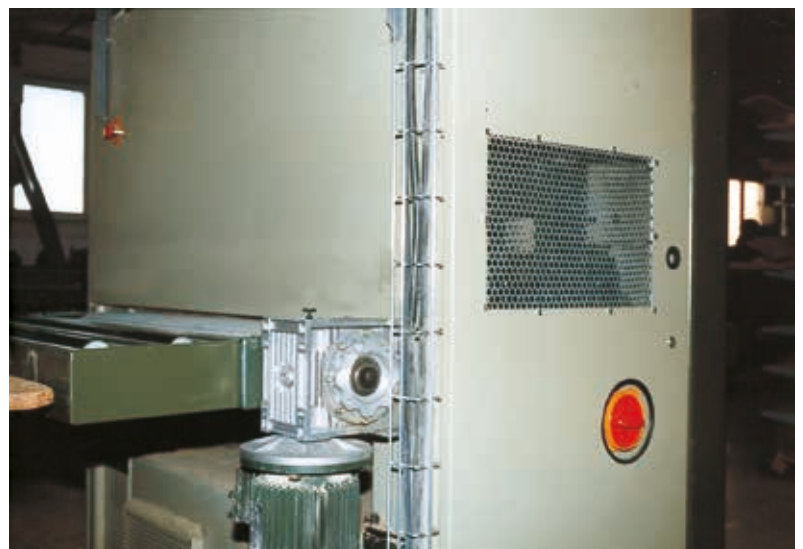
Figure 21. Exemple d'introduction d'air sur une ponceuse à large bande.
