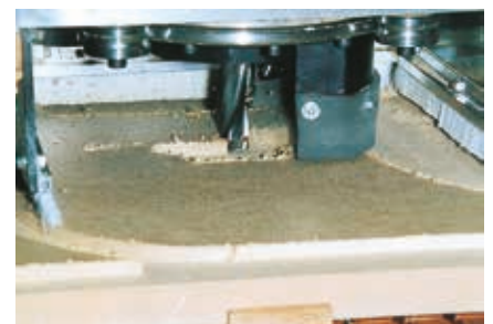
Exemple de dispositif de captage tournant en position de travail.
