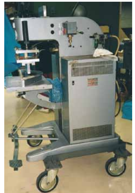
Photo 1. Exemple de machine servant au cintrage du bois.
