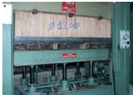
Photo 1. Exemple de machine servant au cintrage du bois.
