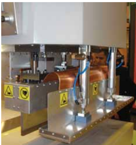
Photo 4. Exemple de machine équipée d'un patin de masse.
