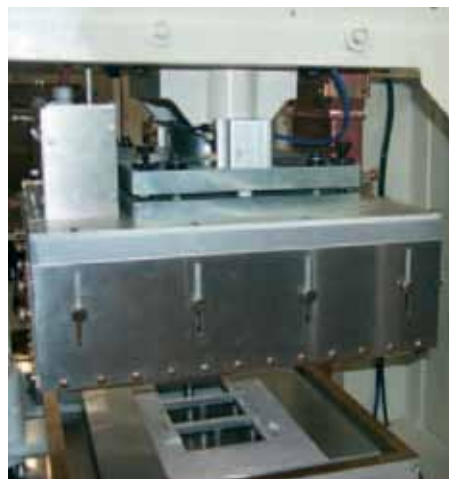
Photo 5. Exemple de blindage d'une zone de soudage.
